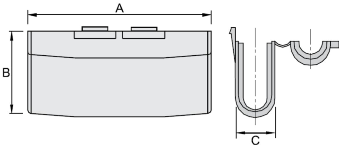
**Figura 1** – Capa para Conector Cunha de baixa tensão
